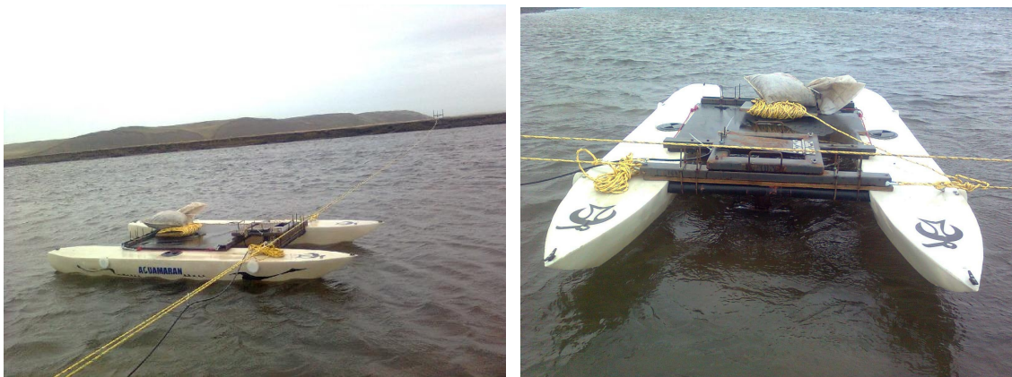
Figura 2: Montaje de la cámara DIDSON para evaluación de abundancia de trucha café en el Río Grande, Tierra del Fuego.
